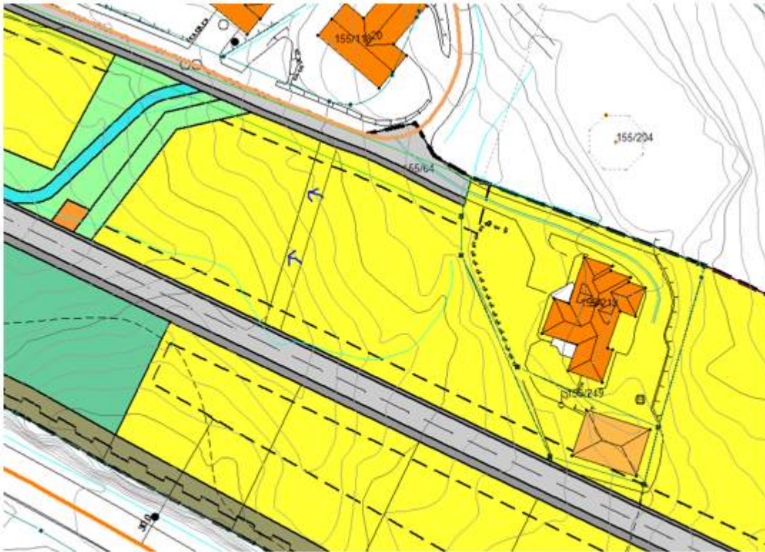
Utklippet over viser både gjeldende og forslag til revidert plan. Vertikal linjer angir regulert tomtegrense, både gjeldende og forslag til nye. Blå piler viser retning på forskyvningen.
